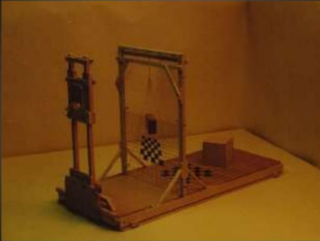
Según Alberto Durero, Reconstrucción de la cámara de retratar o perspectógrafo
