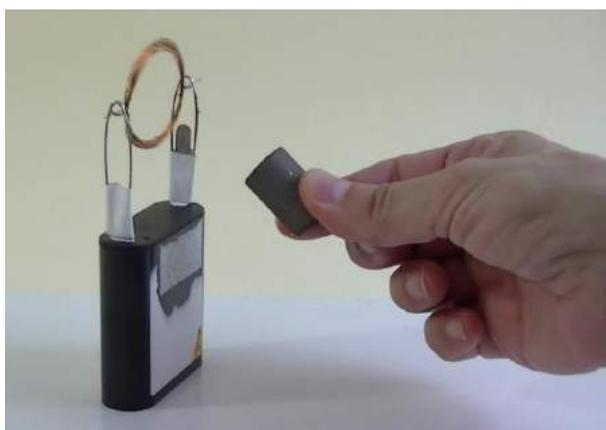
Proponemos construir un motor eléctrico formado por una pila, un cable arrollado en forma de espiral, un imán permanente y dos clips metálicos que harán de soporte de la espiral (tal como se muestra en la imagen).
