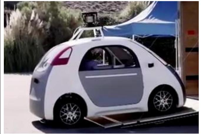
Sobre el techo puede verse el conjunto de cámaras que se utilizan para obtener una visión de 360°
